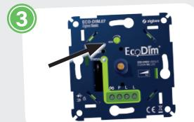
Schalten Sie den Strom wieder ein. Schalten Sie die angeschlossenen Lampen mit der Dimmerwelle ein. Stellen Sie nun MIN wie unter 'Einstellung der Mindestlichtstärke' angegeben ein.
