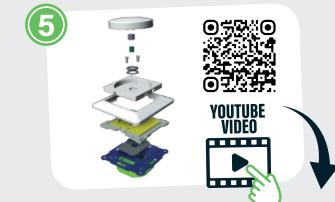
Setzen Sie den Abdeckrahmen, die Zentralplatte und die Dimmtaste wieder auf den Dimmer.
