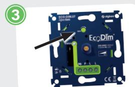
Rétablissementz l'électricité. Allumez les lampes raccordées à l'aide de la tige du variateur. Réglez maintenant le MIN, comme indiqué sous "Réglage du niveau d'éclairage minimum".
