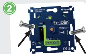
Installieren Sie nun den Dimmer mit den Schrauben in der Unterputzdose.
